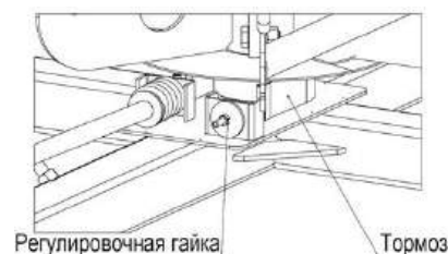
Рис. 4. Регулировка усилия тормоза
