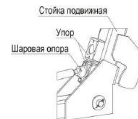
Рис. 5. Установка шаровой опоры
