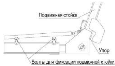
Рис. 7. Положение подвижной стойки при регулировке
